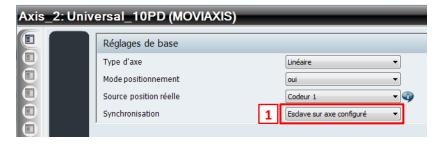
Lors de la première étape de mise en service de l'axe 2, sélectionner ici **"Esclave sur axe configuré"**
