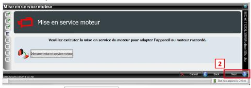
Cliquer sur le bouton pémarrer mise en service moteur afin de parcourir l'assistant de mise en route du MOVIDRIVE® B, permettant la configuration du moteur.
