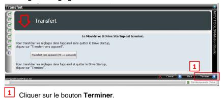
Résultat : Vous avez réglé le MOVIDRIVE<sup>®</sup> B pour un pilotage via le CCU. L'adresse SBus et la fréquence de transmission SBus ont également été validées.
