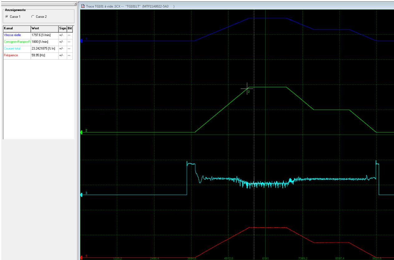
Exemple de Scope (MTF022 avec MTA -30 Dual Motors).
