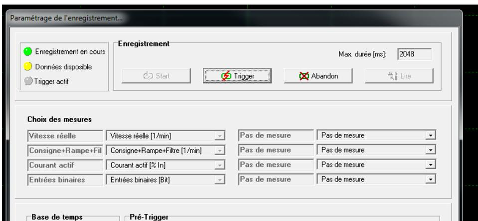
En fonction de la durée d'enregistrement souhaitée, régler la base de temps (ms).
